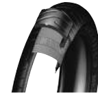
Pneu ceinturé avec carcasse radiale (90 degrés)
